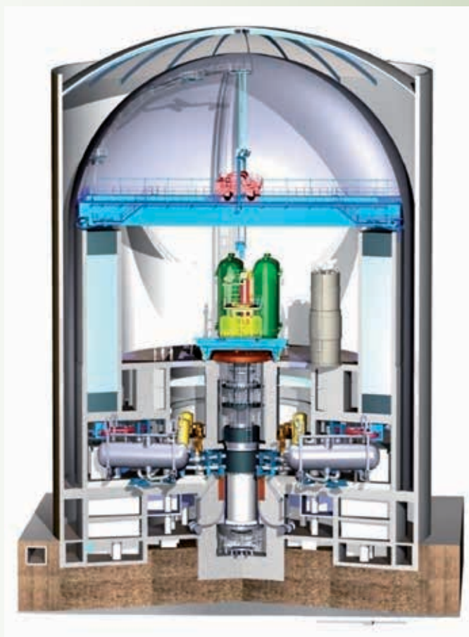
Kontejnment reaktora VVER 440
